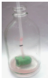
⑤将瓶子放入冰箱至结冰完全。取出瓶子，观察吸管里的水柱高度
